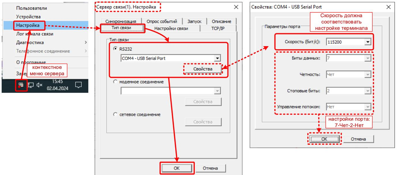
! Параметры последовательного порта для связи с терминалом типа БЭ2502А, БЭ2704 по протоколу SPA-bus:
