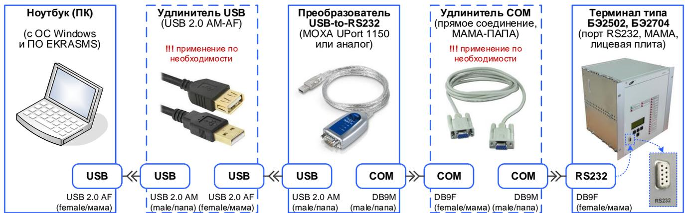
**! Для преобразователя MOXA UPort 1150 необходимо в ОС Windows | Диспетчер устройств \ Многопортовые последовательные адаптеры \ MOXA UPort 1150 в контекстном меню Свойства на вкладке Ports Configurations параметру Interface задать значение RS-232.**
